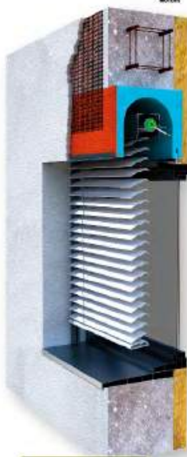
Intégration Coffre Tunnel
