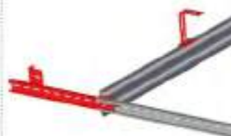
Rallonge de pige pour une pose simplifiée et permet de se fixer sur les murs latéraux
